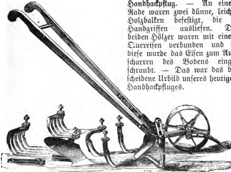
Die Planet jr., kombinierte einrädrige Hacke als Kultivator, Hacke und Pflug.
